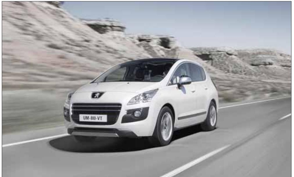
*Le Peugeot 3008 HYbrid4 est le premier véhicule full hybrid diesel au monde. Il combine moteur diesel et moteur électrique, pour une puissance totale de 200 ch. DR*
