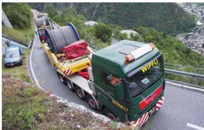
Le quatrième et dernier câble porteur du téléphérique sera acheminé mardi 23 juillet. Le convoi se compose de deux bobines (4 m. de diamètre) chargées sur deux remorques. BITTEL/NF
