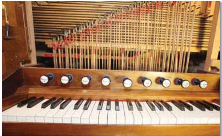
Les tringles relient les touches aux soupapes. REMO
