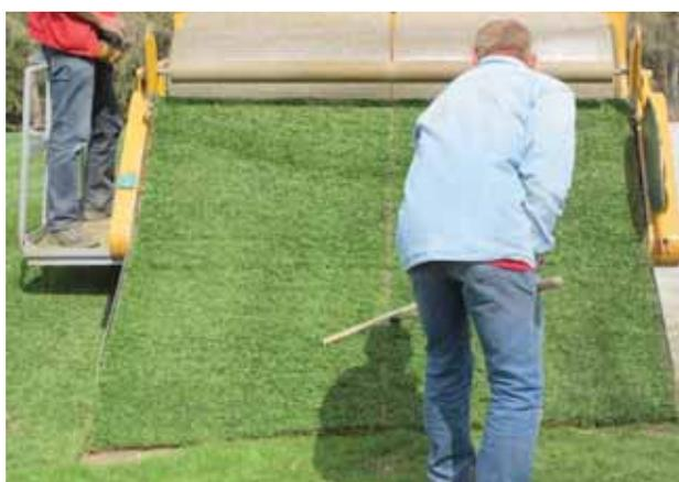
Cette machine allemande, prototype unique, permet de poser des bandes de gazon de 2 m 20 sur 30 mètres. LE JDS
