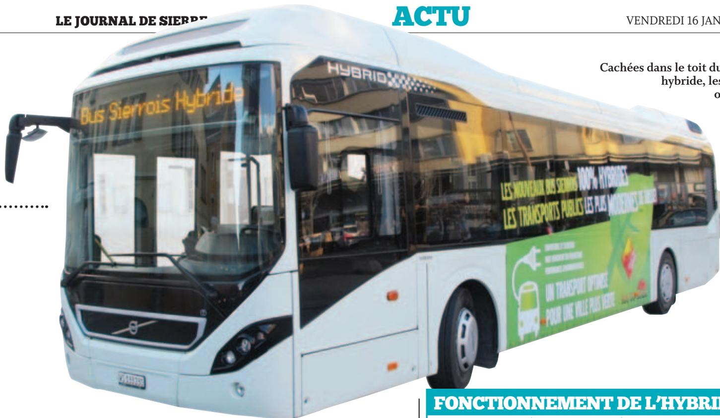
Cachées dans le toit du Volvo hybride, les batteries ont un poids total de 220 kilos. REMO
