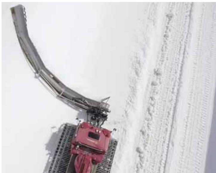
Les machines de CMA sont équipées à l'avant d'une extension permettant d'entretenir le super-pipe. CMA
