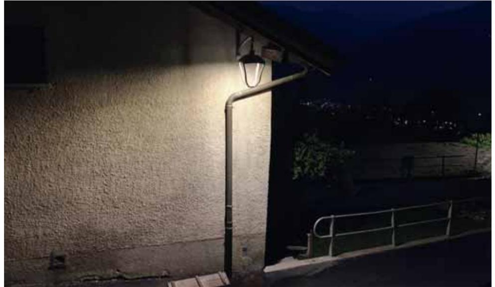
Les communes installent désormais des luminaires, comme ici au village de Randogne, avec un faisceau directionnel permettant de réduire les pertes lumineuses vers les côtés ou le ciel. LE JDS
